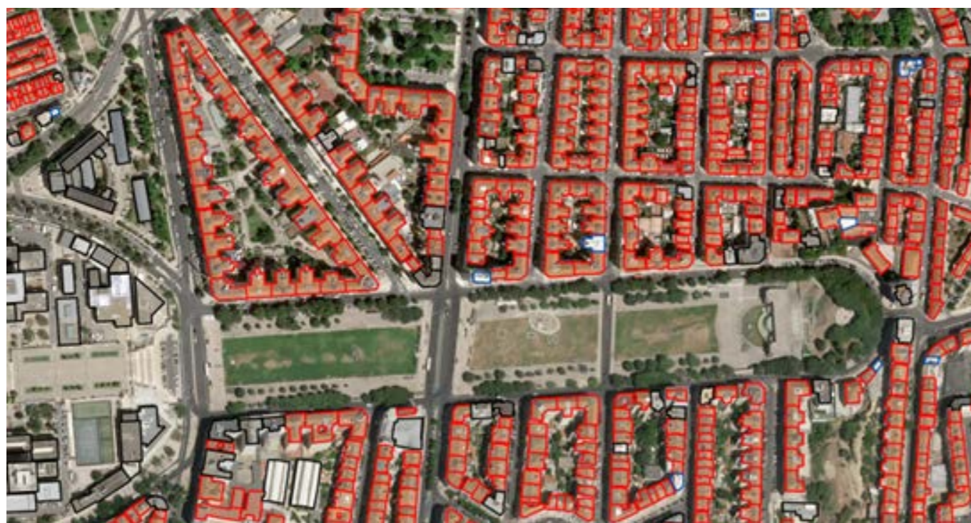
Figura 3. Exemplo de ortofotomapa com edifícios digitalizados manualmente para servir como base de validação
